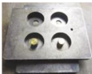
图 2 装有铝、铜嵌件的试样浇注模具
